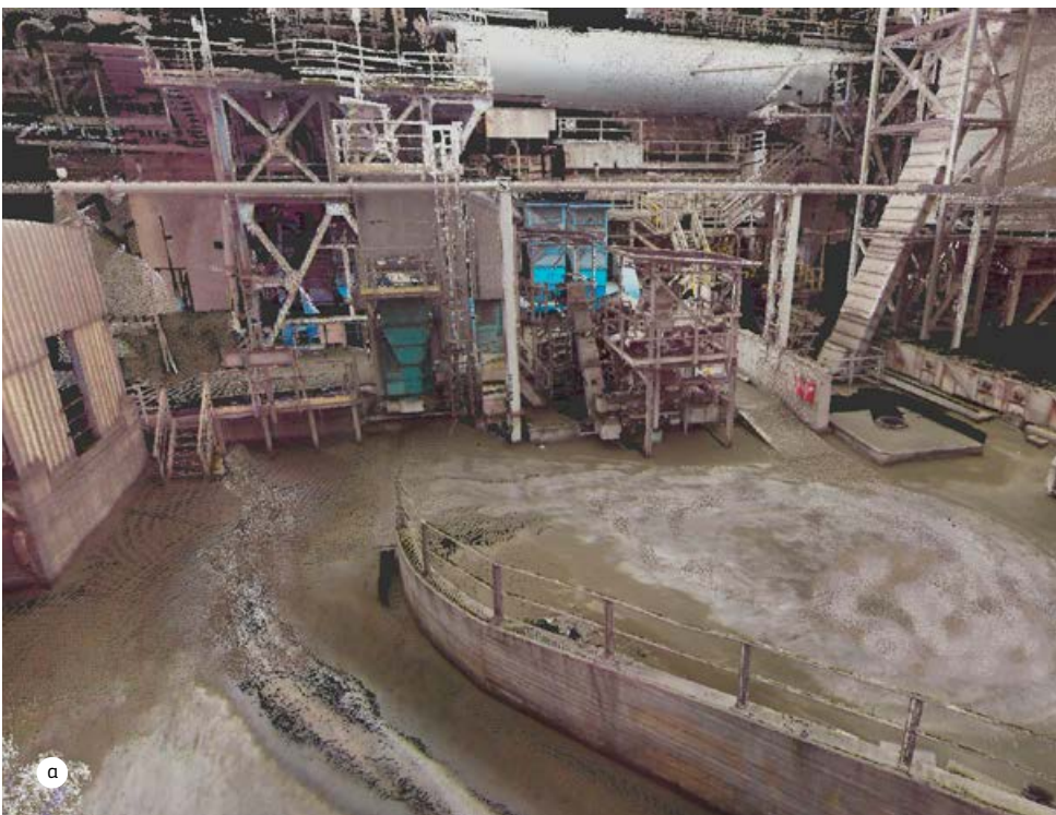
Οι φωτογραφίες δίνουν, από την ίδια περίπου οπτική γωνία, την σειρά εκτέλεσης ενός έργου: α) ψηφιακή αποτύπωση, β) «μοντελοποίηση» από την οποία προκύπτουν τα κατασκευαστικά σχέδια και γ) εκτέλεση.
