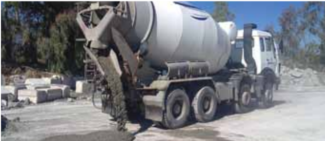
Επιστροφές σκυροδέματος για ανακύκλωση
