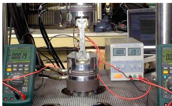
Δοκιμή πιεζοαντίστασης σκυροδέματος
